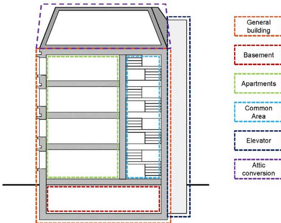
Figure 1. Building model, Source: e7 Energie Markt Analyse GmbH.
